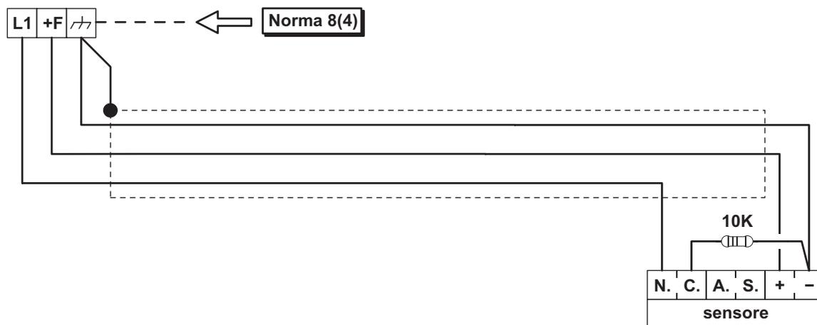
Figura 6 Collegamento di un sensore con linea bilanciata
