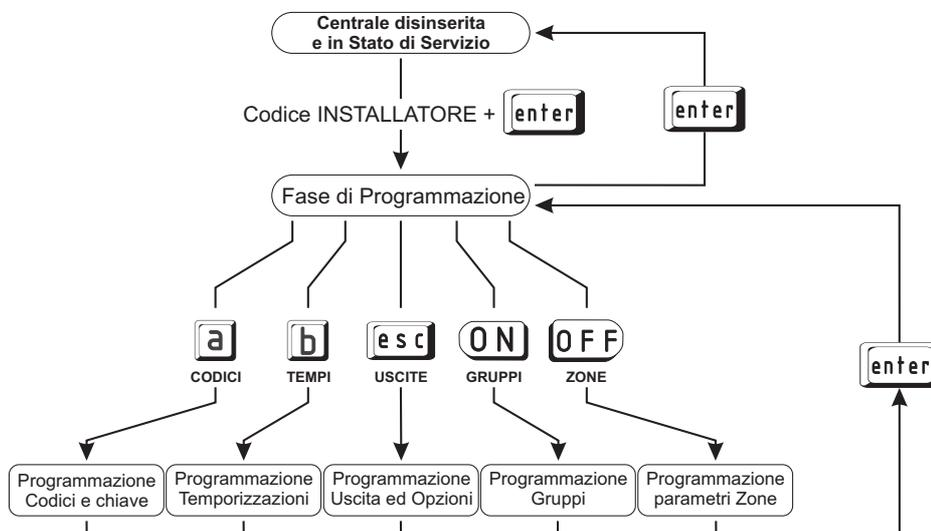
Figura 16 Diagramma di flusso della procedura di programmazione con mascherine
