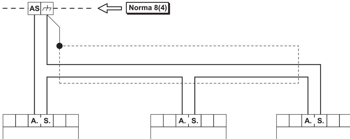
Figura 10 Collegamento dei contatti antisabotaggio
