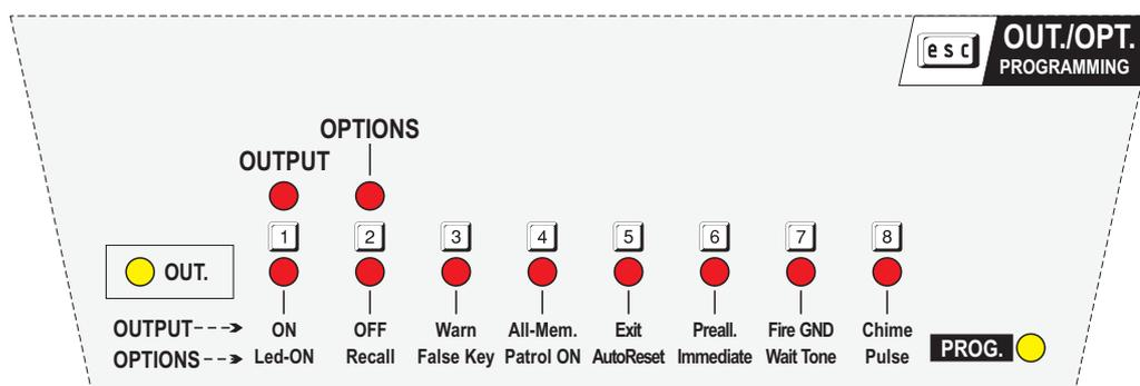
Figura 19 Mascherina per la programmazione delle Uscite e delle Opzioni.
