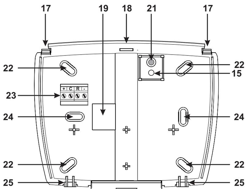
Figura 4 Parti della tastiera di controllo Classika a LED (vista interna).
