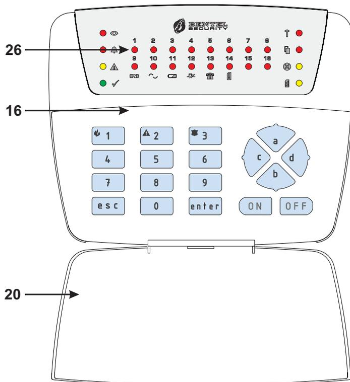
Figura 2 Parti della tastiera di controllo Classika a LED (vista esterna)
