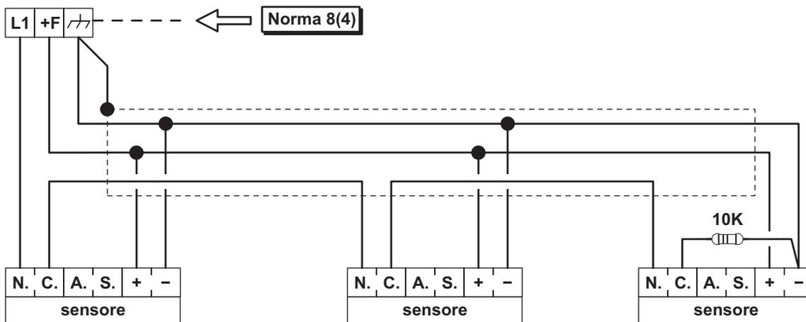
Figura 7 Esempio di collegamento di tre sensori sulla stessa zona bilanciata.
