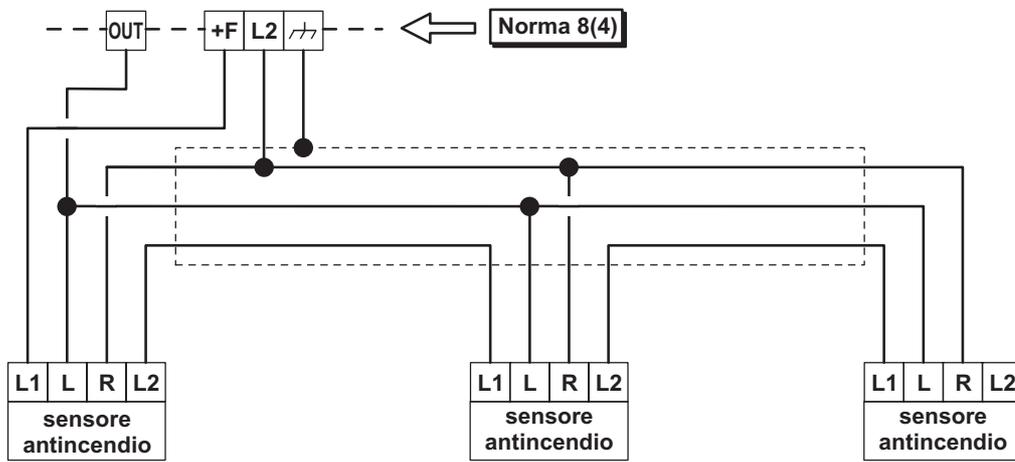
Figura 9 Esempio di collegamento di sensori antincendio
