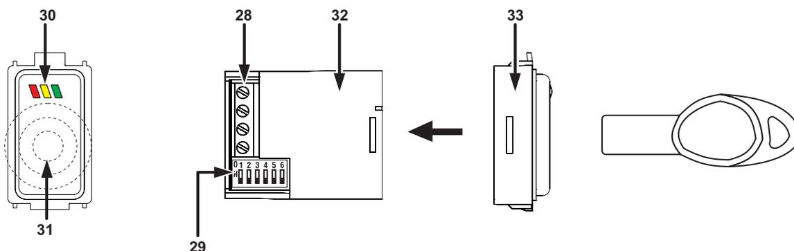
**Figura 5** Parti dell'inseritore Eclipse2 versione Magic e dell'attivatore SAT (il Dipswitch 6 va messo in posizione ON).
