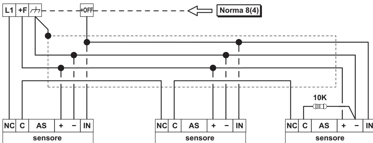
Figura 8 Esempio di collegamento di tre sensori con memoria a comando positivo
